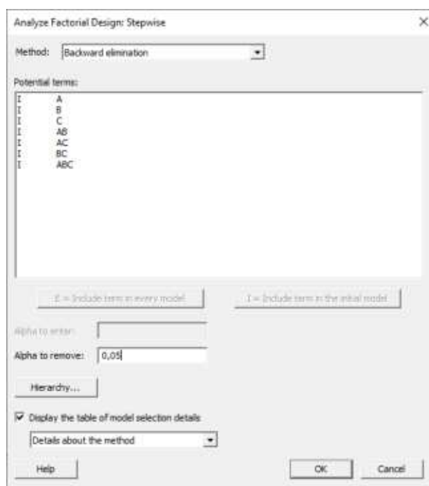
Obr. 16 Voľba spätnej eliminačnej metódy pri vylúčení nesignifikantných členov
