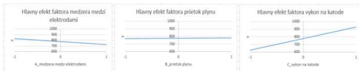
Obr. 144 Vizuálne porovnanie veľkosti hlavných efektov skúmaných faktorov umožňuje nastavenie rovnakej mierky y-ovej osi v Exceli
