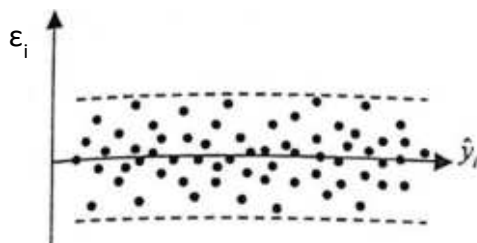
Obr. 36 Rezíduá neprejavujú systematické tendencie a spadajú do horizontálneho pásu sústredeného okolo nuly [14]
